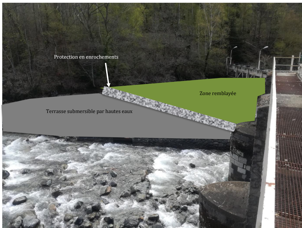
Figure 4: vue schématique de l'aménagement projeté à l'amont de l'ouvrage
